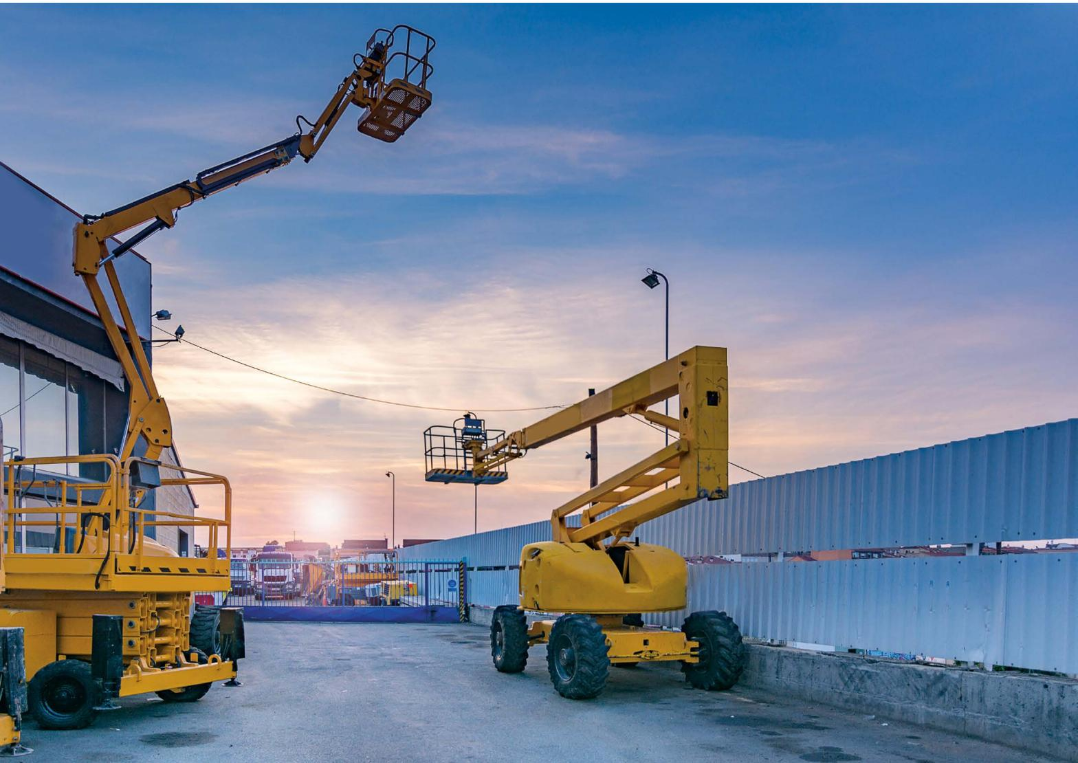
ses distances avec tout obstacle, avec les pentes, les fondrières, les rampes, et bien voir en tout temps le sol sur lequel on se déplace. En outre, il sera interdit d'utiliser un appareil de levage de personnes pour transférer du personnel d'un étage à un autre ou encore de quitter la plateforme ou d'y entrer lorsqu'elle est en hauteur. Si d'autres moyens d'accès réglementaires ne peuvent être utilisés, l'employeur pourra utiliser une plateforme, mais sous certaines conditions.
